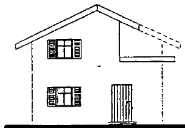
EDIFICIO CON COPERTURA PIANA E FALDA ATTIGUA CON PENDENZA TRADIZIONALE
